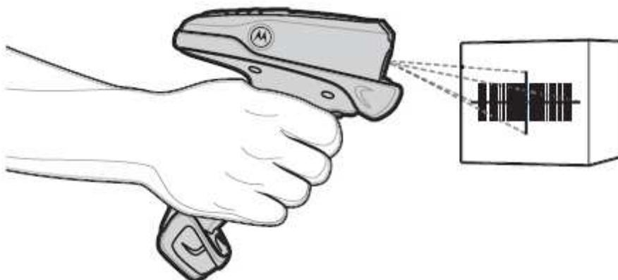
**Рисунок 3-1** Сканирование в ручном режиме
