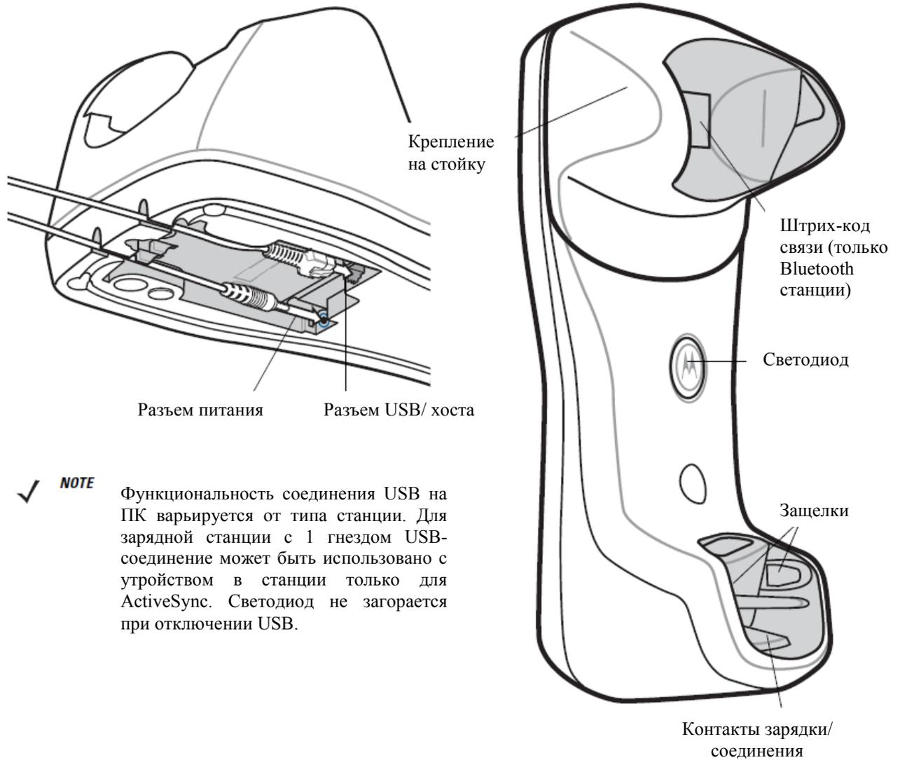
**Рисунок 1-2** Базовая станция с 1 гнездом – соединения/ штрих-код связи
