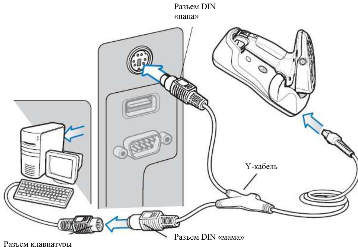
**Рисунок 11-1** Подключение Keyboard Wedge с Y-образным кабелем
