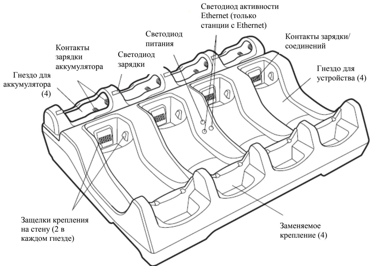
**Рисунок 1-5** Базовая станция с 4 гнездами – вид спереди
