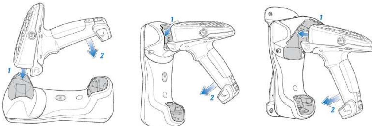
Рисунок 1-9 Вставка устройства в базовые станции с 1 гнездом
