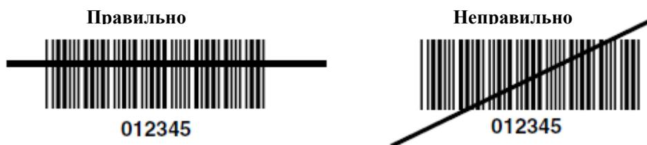
**Рисунок 3-5** Ориентирование сканирования при помощи лазерного рисунка наведения
