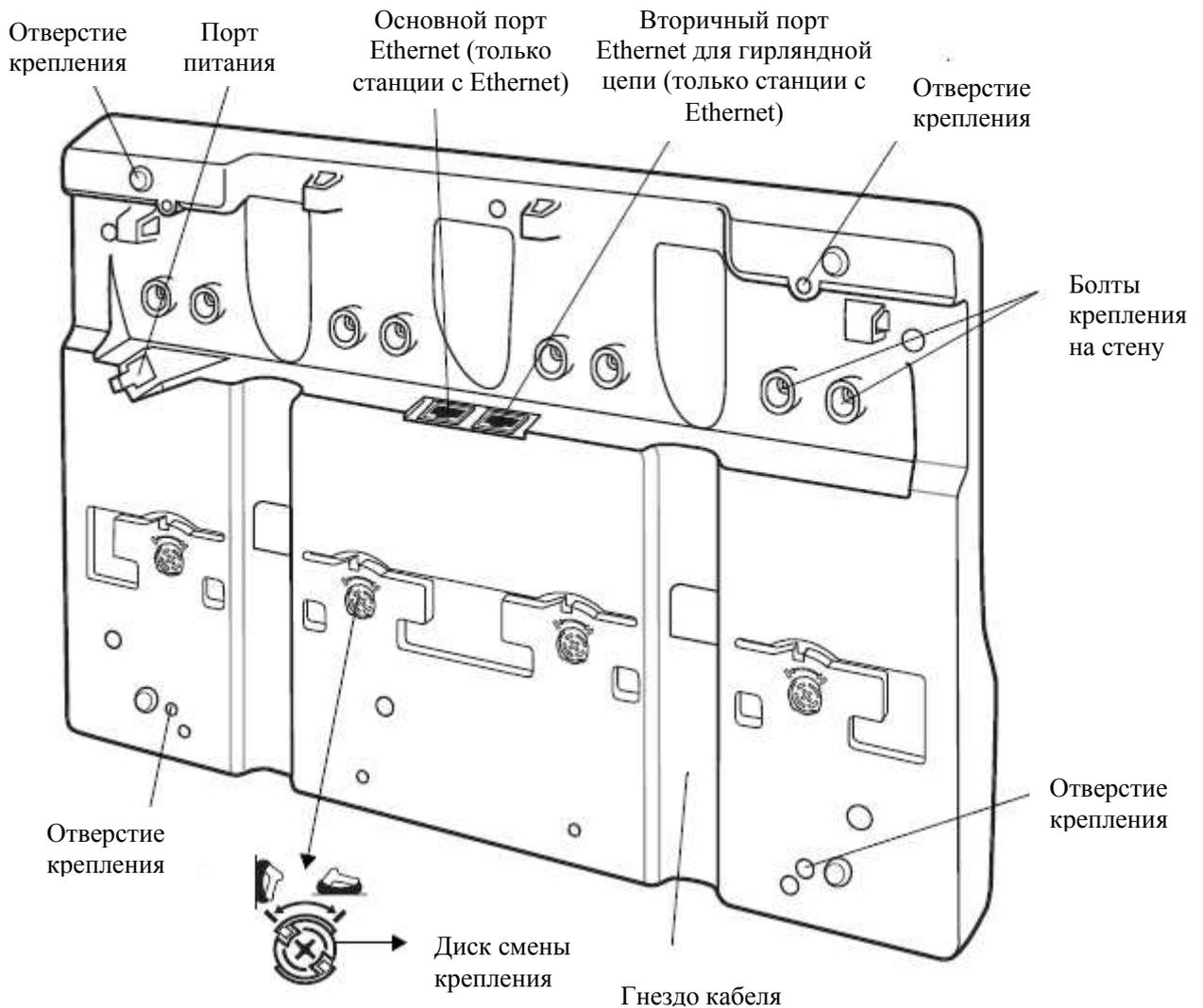
**Рисунок 1-6** Базовая станция с 4 гнездами – вид сзади
