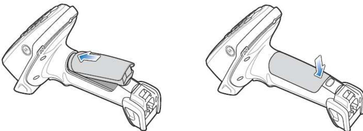
Рисунок 1-8 Вставка аккумулятора
