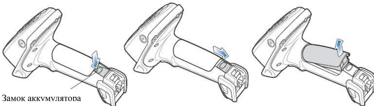
Рисунок 1-11 Извлечение аккумулятора
