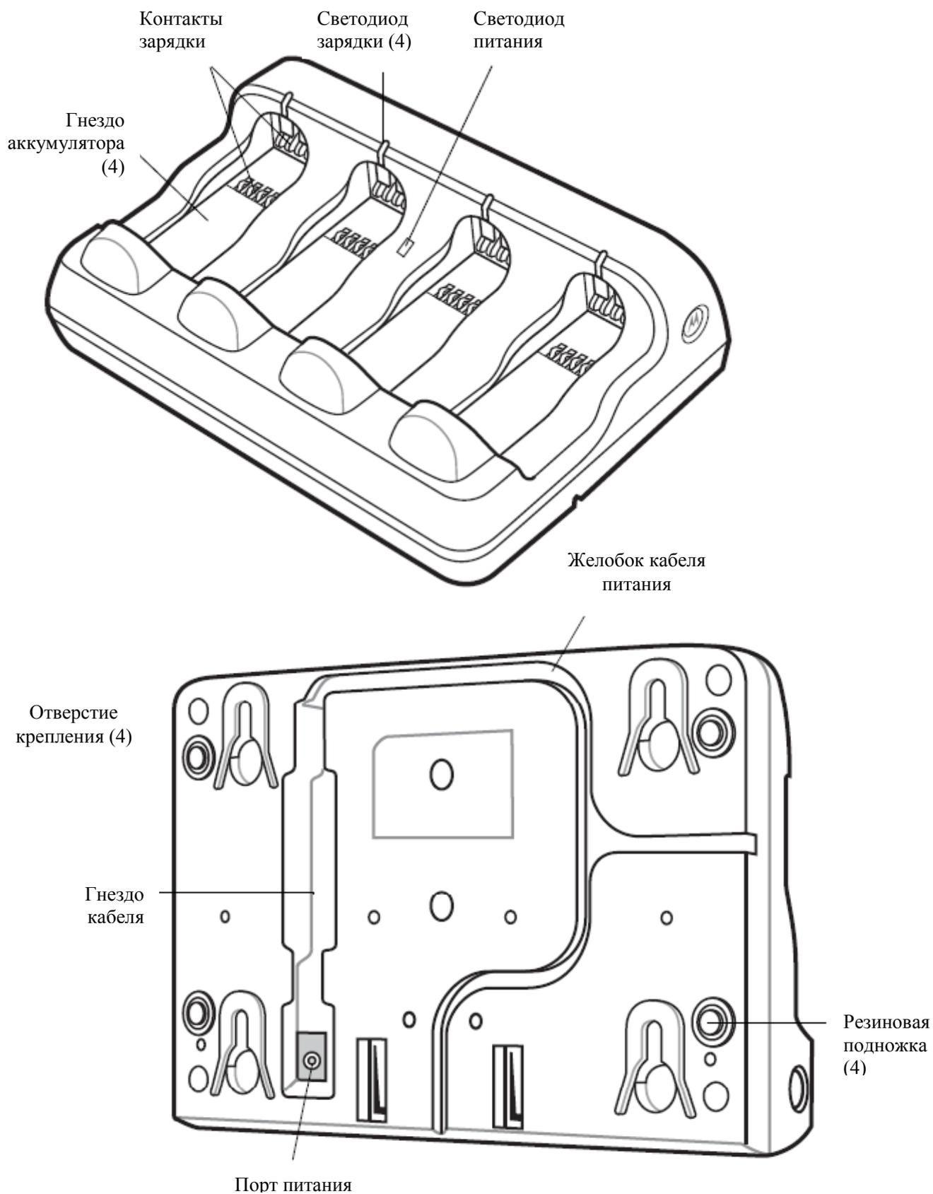
**Рисунок 1-7** Зарядное устройство запасных аккумуляторов с 4 гнездами
