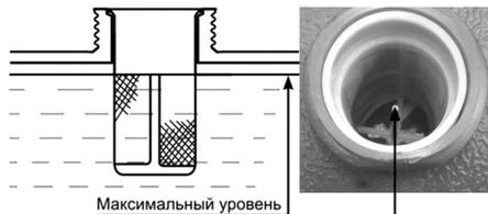
**Рис. 25 Максимальный уровень топлива во внешнем баке**
