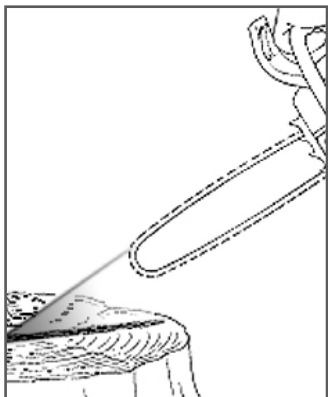
Рис. 7 Проверка смазки шины и цепи
