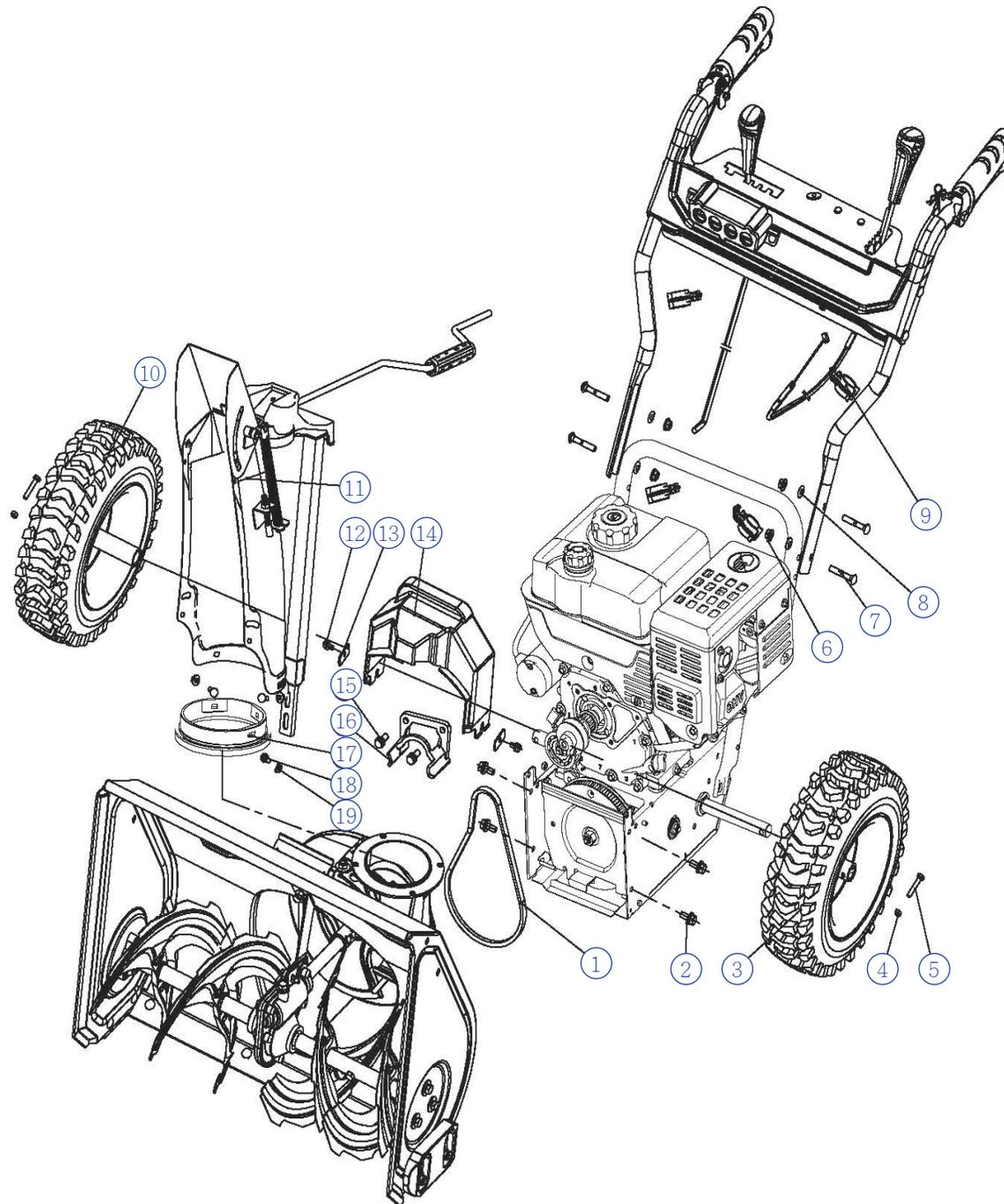
**Модель агрегата: WB5561 (Снегоуборщик 4,05 кВт /5.5 л.с. 196 см<sup>3</sup>)
