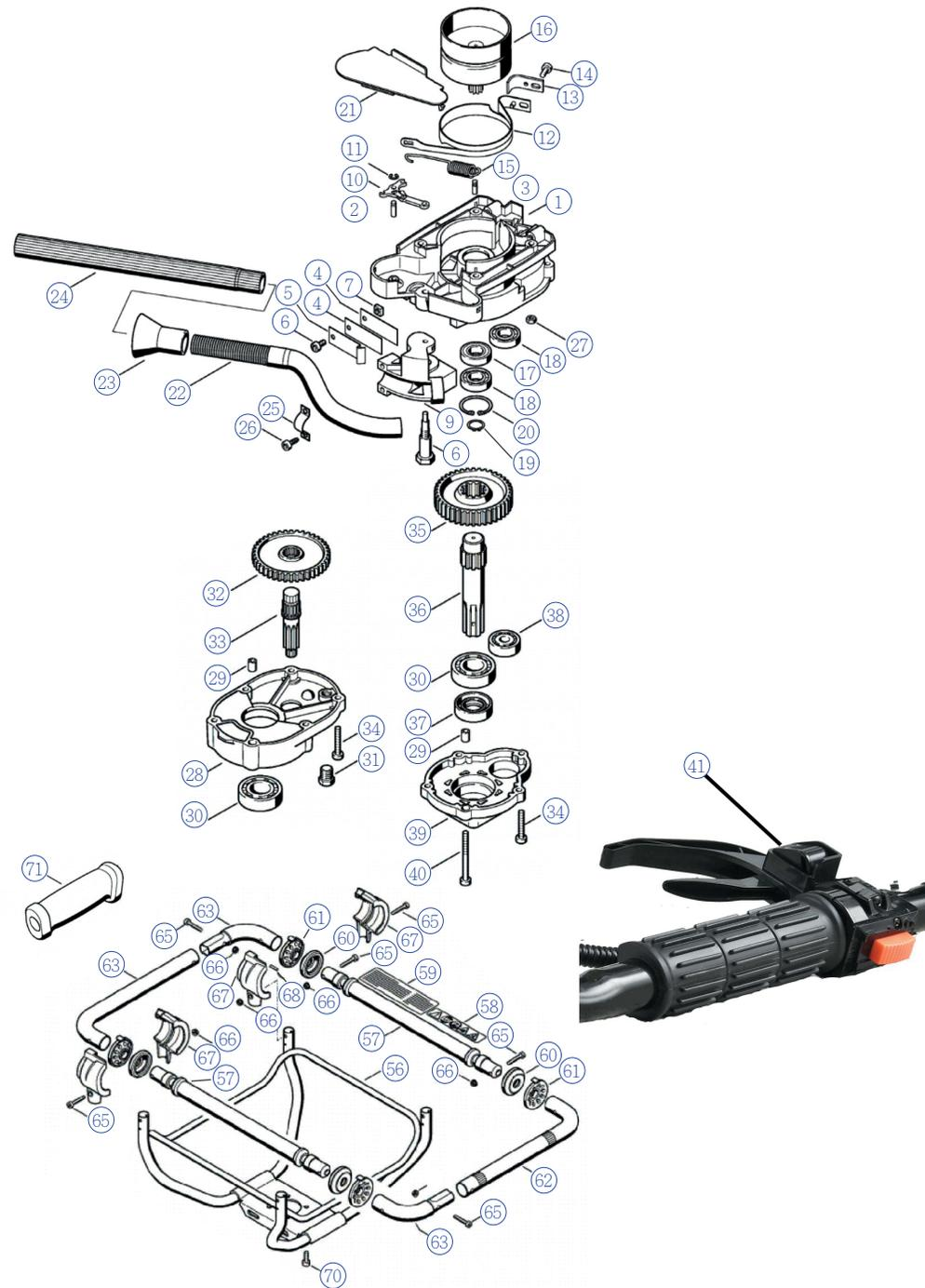
**Модель агрегата: D427 ( Бензобур 1,47 кВт /2 л.с. 41,5 см<sup>3</sup>)****Редуктор - рама.****Список запасных частей**
