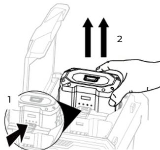
Кнопка отсоединения аккумулятора
