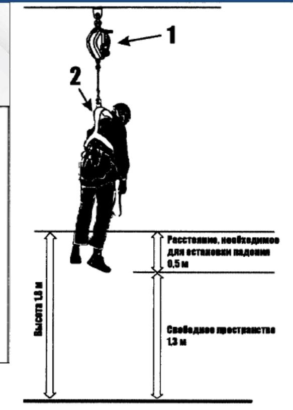
**Запас высоты** рассчитывается с учетом суммарной длины стропа и соединителей, с учетом длины сработавшего амортизатора, роста работника, а также свободного пространства, остающегося до нижележащей поверхности в состоянии равновесия работника после остановки падения.
