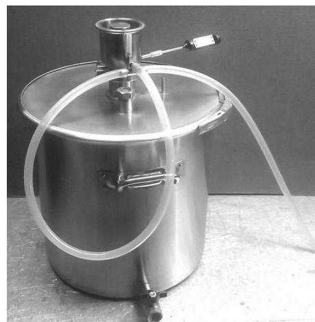
Рисунок 3. Петля сифона на НБК для жидких браг
