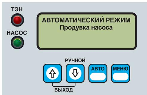
Эта операция полезна, чтобы выгнать пузырьки воздуха вокруг контуров и крыльчаток насоса. В конце этой фазы запускается насос, и вода рециркулирует.
