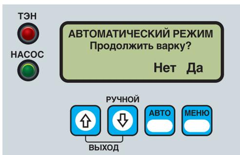
Если предыдущий запуск был по какой-то причине прерван, система спросит, желает ли пользователь возобновить предыдущий процесс. При положительном ответе система возобновит точно с шага, где процесс был прерван; в противном случае система стартует с первого шага затирания.
