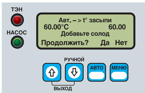
После того, как пользователь подтверждает продолжение, система входит в следующую фазу цикла, чтобы позволить загрузить зерно в бункер солода.
