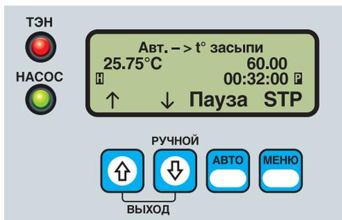
Система начинает нагревание и рециркуляцию воды, и когда достигается температура начала затирания — система входит в состояние паузы/цикла.
