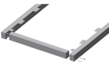
Сборку лестницы начинают со сборки площадки размером 900x1800 мм из 4х металлических балок (поз. 2, 3, 4), скрепив каркас площадки болтами M8x80 мм (8 шт.).
