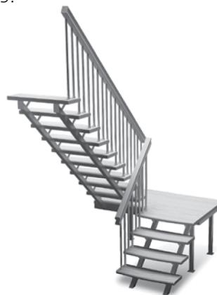
Опоры крепят к ступеням саморезами 3,5x20 мм через фланцы и болтом M8x50 снизу. Фланец фиксируется к стойке винтом или саморезом по металлу. Поручни перил (поз. 10 и 11) закрепляются к стойкам петлей M8.
