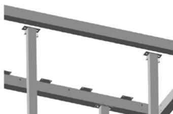
К собранному каркасу площадки прикрепляют 4 опоры (поз. 1) болтами M8x20/30 (8 шт.)
