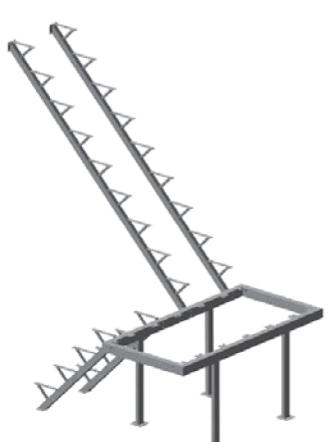
Производят окончательную затяжку крепежа тетив с площадкой. Кронштейн тетив к полу нижнего этажа и к стенке верхнего этажа прикрепляют анкерными болтами(анкерные болты в комплекте не поставляются).
