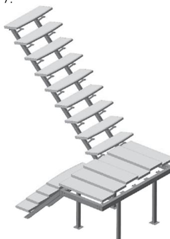
На собранный и закрепленный каркас устанавливают деревянные ступени (13 шт, поз. 8) и сборную площадку, состоящую из шести досок 900x300 мм (поз. 7). Ступени и площадка закрепляются саморезами 3,5x35 мм.
