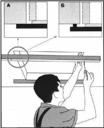
2. Монтаж осуществляется силами двух человек. Один из них поднимается вместе с лестницей и инструментом на верхний этаж. Для установки лестницы в проеме необходимо снизу закрепить две временные опоры, как показано на рисунке.
