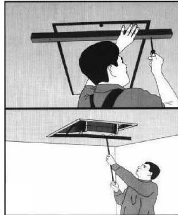
4. Далее возможно убрать вспомогательные опоры и открыть лестницу. После раскладывания лестницы ее каркас фиксируется в проеме по длинным сторонам. Оставшиеся пустоты заполняются изолирующими материалами.
