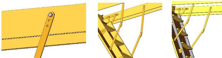
5. Для регулировки длины и угла наклона лестницы можно изменить местоположения креплений боковых ограничителей используя предназначенные для этого отверстия.
