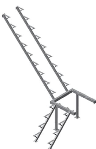
К полученной конструкции аналогичным образом крепят две нижних тетивы длиной 1200мм(поз. 5).
