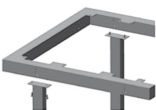
К собранному каркасу площадки прикрепляют 2 опоры (поз. 1) болтами M8x20/30(4 шт.).
