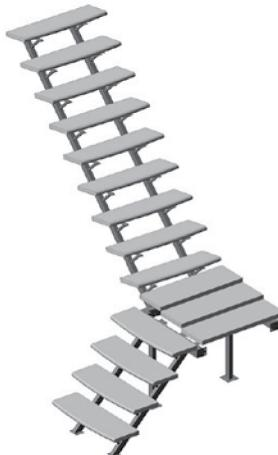
На собранный и закрепленный каркас устанавливают деревянные ступени(13 шт., поз. 8) и сборную площадку, состоящую из трех досок 900x300мм(поз. 7). Ступени и площадка крепятся саморезами 3,5x35мм.
