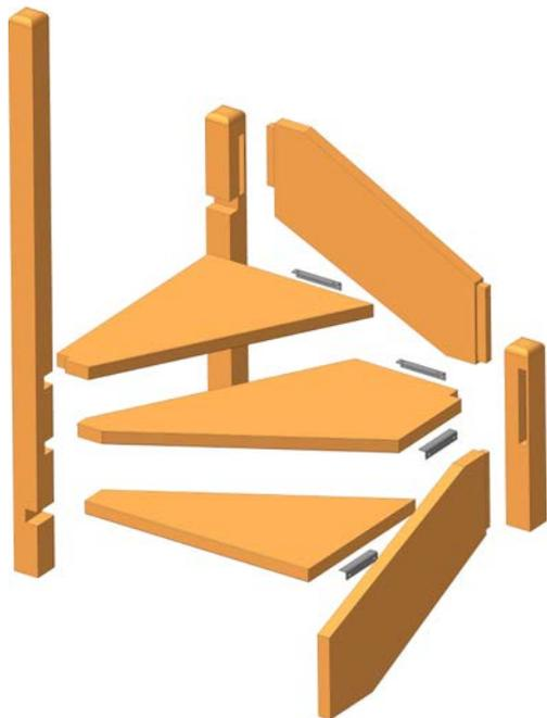
1. Сборку лестницы начинают соединив основание из трех опорных столбов (поз. 1 и 2), двух нижних струн (поз. 3 и 4) и трех нижних ступеней (поз. 5, 6 и 7). Струны и ступени устанавливаются в соответствующие им выборки и пазы в столбах. Между собой их скрепляют саморезами 3,5x70 мм
