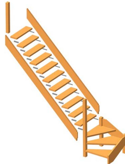
6. На плоскости верхнего этажа устанавливают столб (поз. 10). Отдельно собирают конструкцию состоящую из основания (поз. 11), семи балясин (поз. 13) и поручня (поз. 12). Между собой элементы скрепляются саморезами 3,5x70 мм
