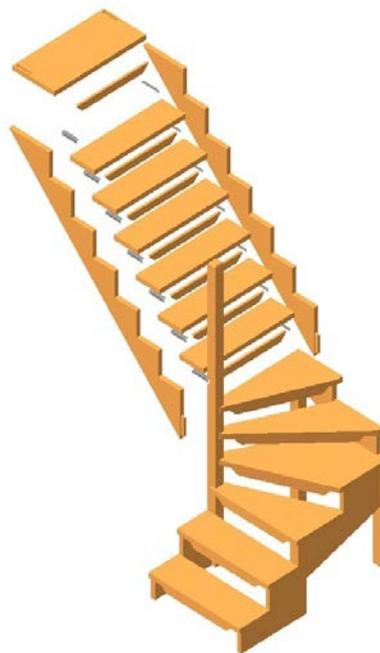
5. К опорным столбам (поз. 1 и 2) в пазы устанавливают верхние струны (поз. 16 и 17). Крепят саморезами 3,5x70 мм. Лестницу устанавливают в месте использования и надежно крепят к перекрытиям и стенам помещения (крепеж в комплект поставки не входит).
