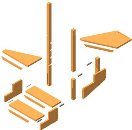
1. Сборку лестницы начинают соединив две нижних струны (поз. 5) со столбами 2380 мм и 583 мм (поз. 1 и 4). Далее крепят боковую струну (поз. 6) и столб 790 мм (поз. 3). Струны устанавливаются в пазы и крепятся саморезами 3,5x70 мм (по 2 шт. на соединение).
