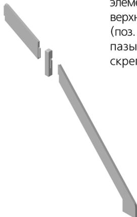
2. Полученную наружную струну и верхнюю боковую струну лестницы (поз. 12) соединяют с угловым столбом 2530 мм (поз. 2). Крепят саморезами 3,5x70 мм.
