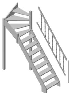
8. После установки и осадки лестницы весь крепеж затягивают окончательно.
