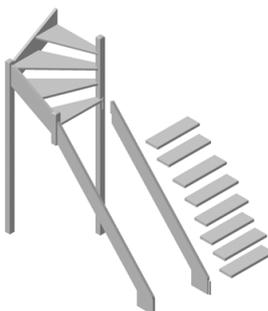
5. Между нижними струнами, с шагом 223 мм, последовательно монтируют нижние ступени 705x205 мм (поз. 6). Крепление к струнам посредством металлических уголков и саморезов 3,5x35 мм.
