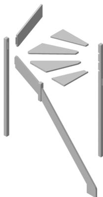
3. Собирают поворотную секцию, состоящую из ступеней №9-12. Узкие части ступеней крепятся в пазы опорного столба 2900 мм (поз. 3). Широкие части ступеней к струнам крепятся посредством металлических уголков и саморезов 3,5x35 мм. В торцах струн выбран специальный паз для скрытого монтажа уголков. Необходимо только срезать оставшуюся часть, в зависимости от правого или левого направления поворота.
