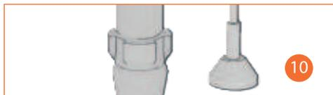
4. Поверните кран заливки «6» вверх для закрытия дренажного клапана.
