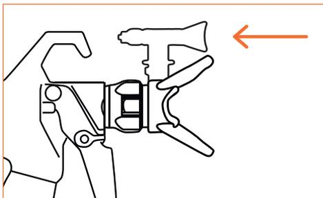
4. Прижмите распылитель к заземленной металлической емкости с жидкостью для промывки. Снимите курок распылителя с предохранителя и нажмите. Из шланга высокого давления выйдет жидкость.
