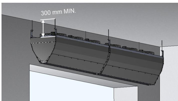
Для того чтобы правильно смонтировать завесу в горизонтальном положении, необходимо предусмотреть мин. расстояние 300 мм от задней панели завесы до стены или потолка.
