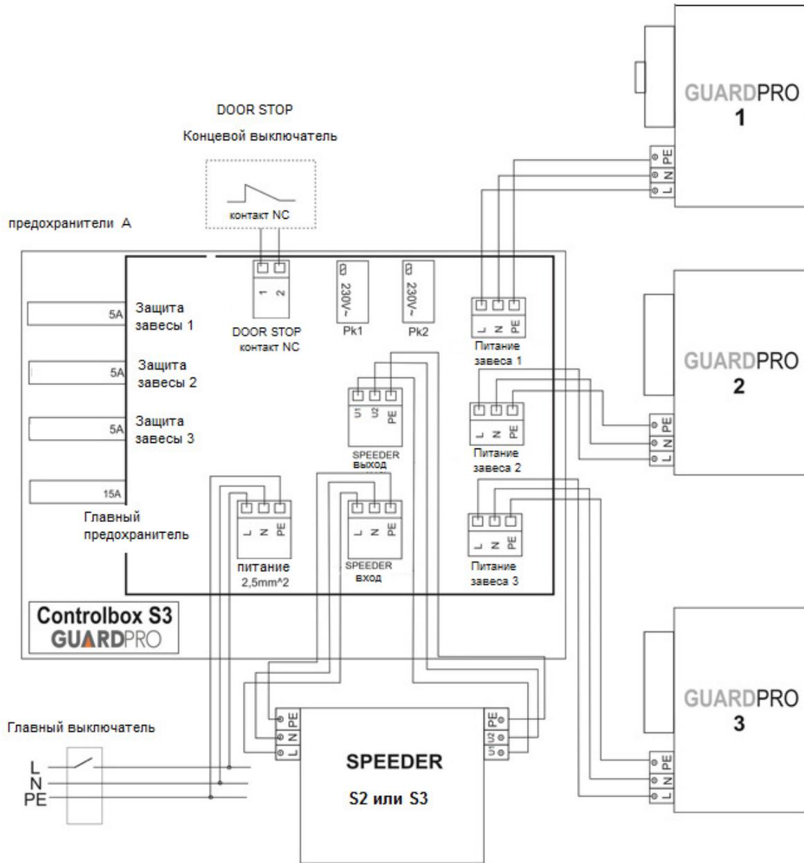
Схема завес GUARDPRO с использованием шкафа управления ControlBox S3 без регулятора скорости
