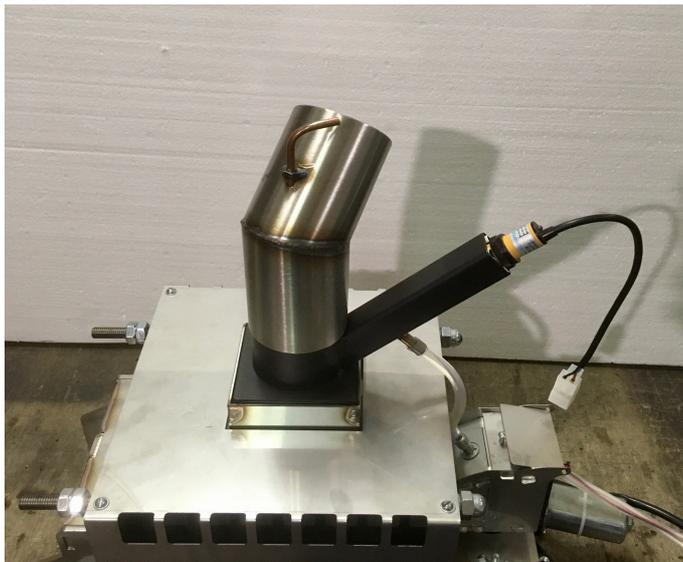
Необходимо правильно выбирать мощность работы горелки в зависимости от мощности котла и объема его камеры сгорания. Черный дым из дымовой трубы свидетельствует об избыточной мощности горения. Несоответствие выбранной мощности объему камеры сгорания котла ведет к образованию сажи и загрязнению котла и дымохода. Для уменьшения мощности нужно переместить ниже пластину на наклонном колоснике или заменить гребенку.
