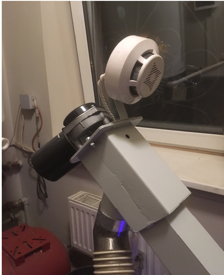
Расположение датчика дыма на шнеке.
