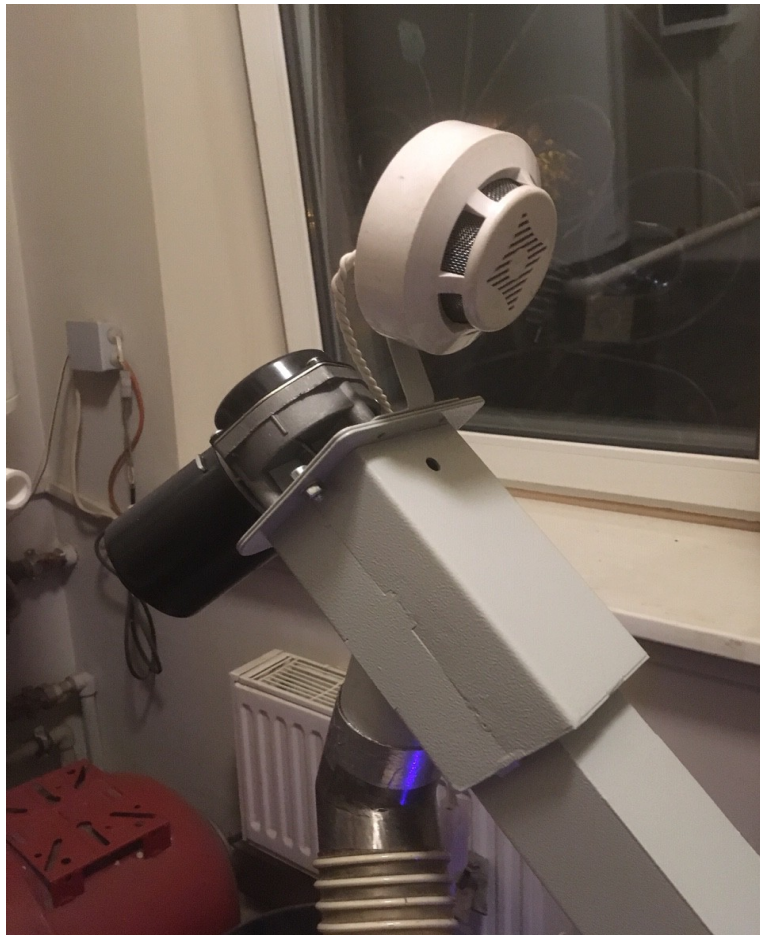
Расположение датчика дыма на шнеке.
