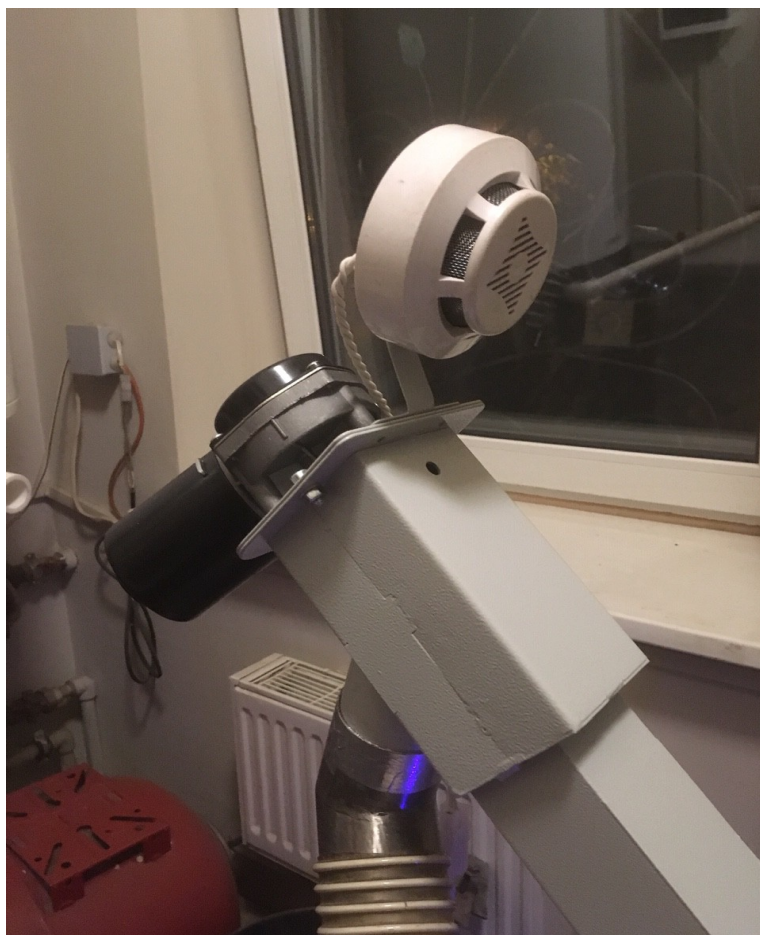
Расположение датчика дыма на шнеке.
