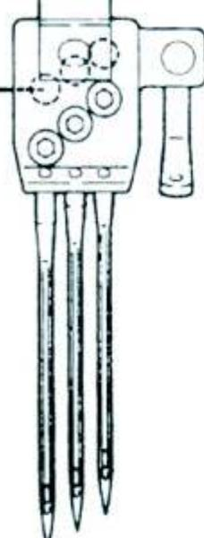
Тщательно проверьте иглу и убедитесь, что паз обращён к задней части машины.
