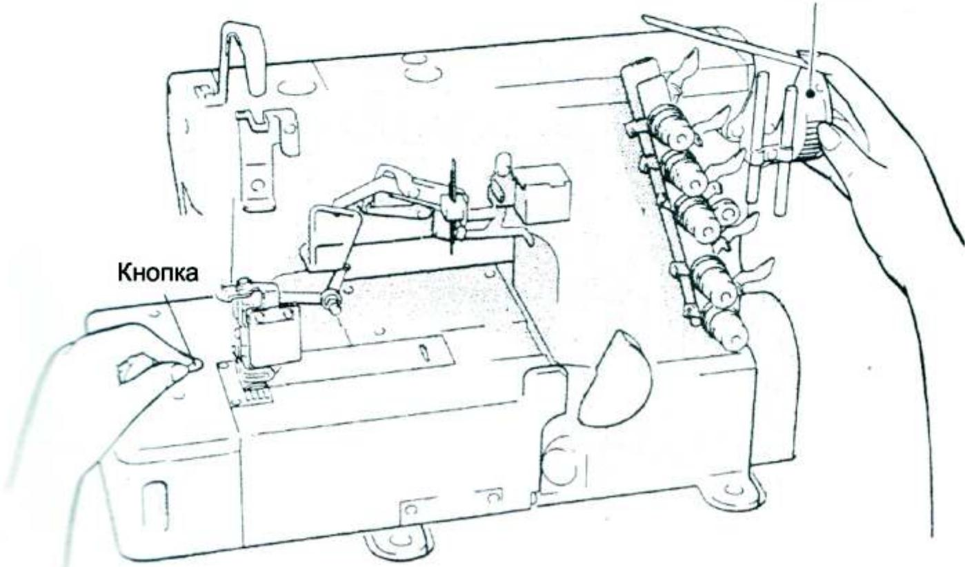
Отрегулируйте натяжение нити с помощью регулятора натяжения игольной нити (1), регулятора натяжения нити верха (2) и регулятора натяжения нити петлителя (3).
