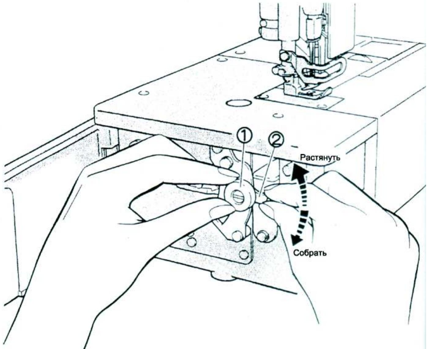
Нажмите и удерживайте кнопку, одновременно поворачивая маховик; определите положение, в котором кнопка западёт глубже. Затем, удерживая кнопку в нажатом состоянии, поворачивайте маховик и установите необходимую длину стежка, согласно регулировочной отметке.
