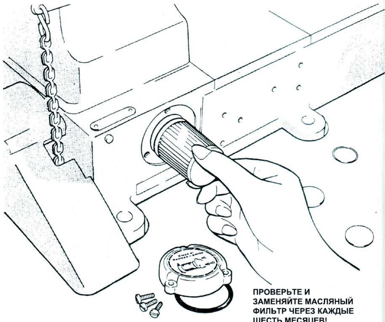
Примечание: на машинах, оборудованных устройством УТ, необходимо снять скобу соленоида.
