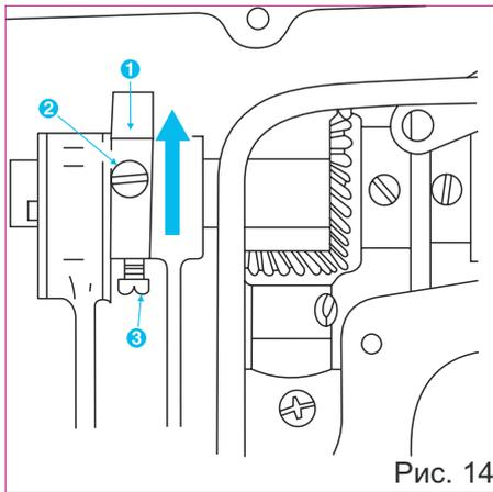
1. Ослабьте винты (2) и (3) рис.14, эксцентрика подачи (1). Поверните эксцентрик подачи (1) в направлении, указанном стрелкой (или в противоположном), и крепко затяните винты (2) и (3).
