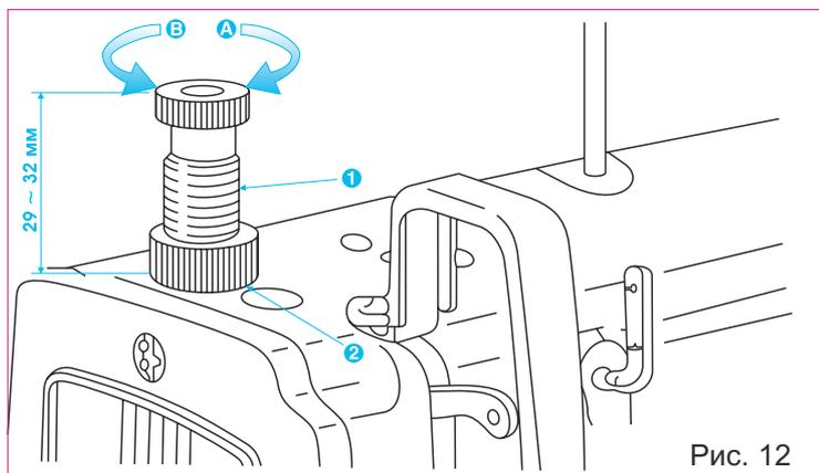
1. Ослабьте гайку (2) рис.12. При вращении регулятора давления пружины (1) по часовой стрелке (в направлении А), давление лапки на ткань увеличивается.
