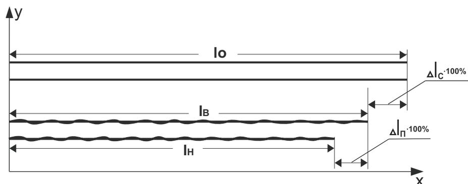
1. **Посадка ткани** определяется линейкой \$l=500\$ и выражается в виде сдвига \$l\_H\$ нижнего слоя ткани относительно \$l\_B\$ верхнего слоя ткани.
