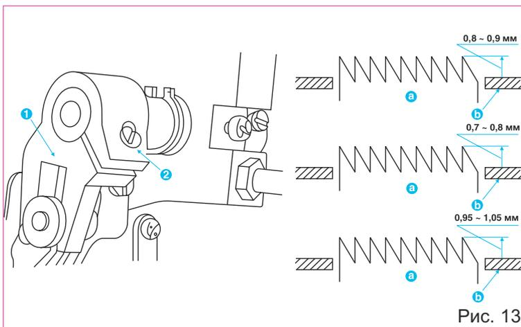
1. Заводская установка высоты подъема рейки (а) рис.13, над игольной пластиной (b) составляет 0,8~0,9 мм.
