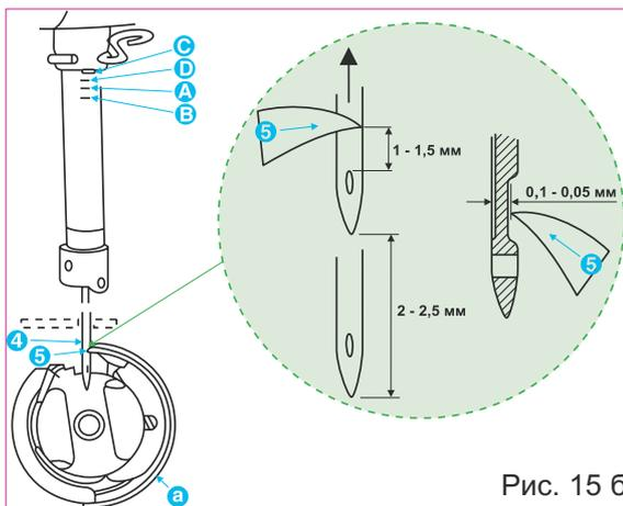
Своевременность подхода носика (5) челнока (а) к игле(4) обеспечивается поворотом челнока после ослабления двух установочных винтов (рис. 15б).
