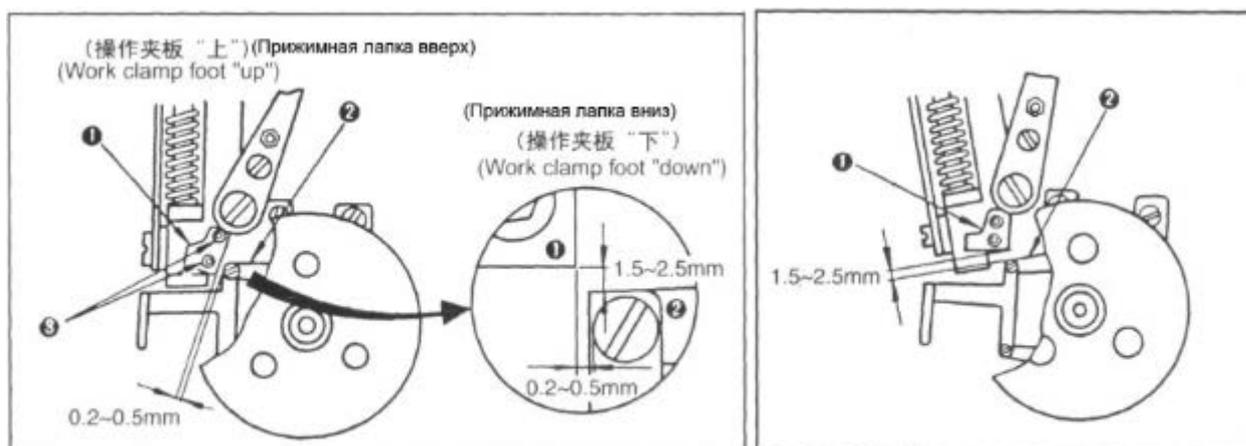
2. Убедитесь, что продольный зазор в 1,5,-2,5 мм между предохранительной пластиной (1) и подъемным рычагом (2) сохраняется во время высокоскоростного шитья закрепок при опущенной прижимной лапке.
