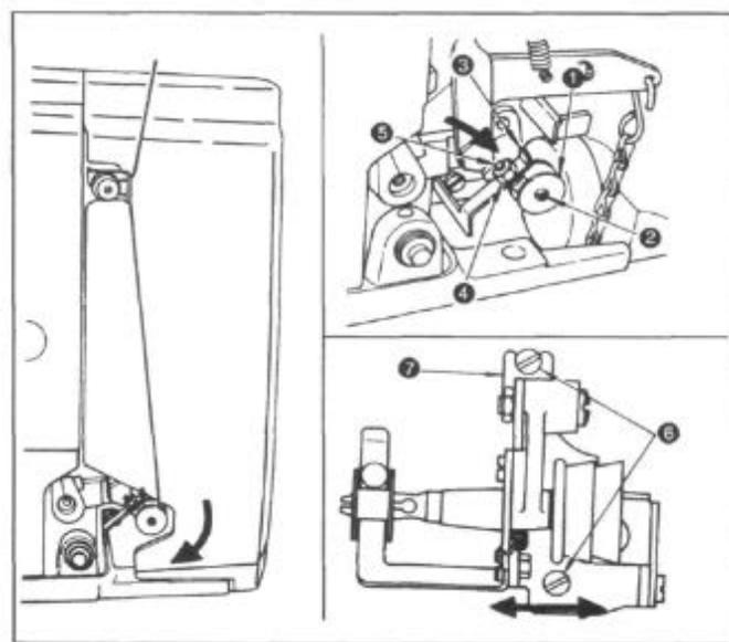
5. Если нить наматывается на шпульку неровно, ослабьте винт (6) и передвиньте основание станка для каркасной намотки (7) в направлении, указанном стрелкой.
