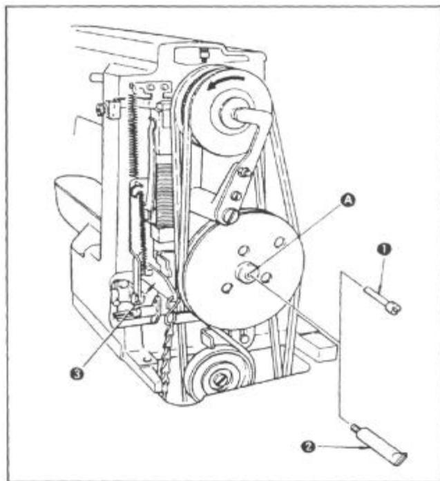
**Внимание!** Если смазочное вещество не проходит в отделение равномерно, ввинтите тюбик (2), включите электродвигатель и поверните несколько раз рычаг (3). Таким образом, смазочное вещество попадет в отделение легко.
