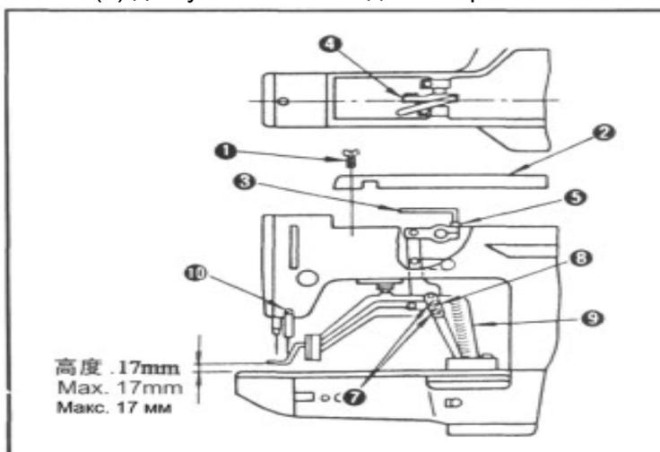
**Внимание! Не вызовите столкновение поддерживающей планки рычага прижимной лапки (8) со скобой продвижения (9). Если поддерживающая планка рычага прижимной лапки сталкивается со щеткой, отрегулируйте положение щетки, используя установочный винт (10).**
