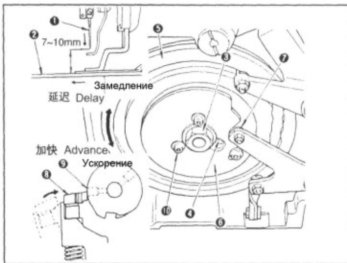
3. После регулировки тщательно затяните винт с углублением в головке (4) и шестигранную гайку (3).
