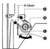
Длина хода нитепритягательной пружины составляет 8 - 10 мм. Если стачиваются тонкие ткани, уменьшите натяжение нитепритягательной пружины и увеличьте ее ход. При стачивании толстых тканей необходимо увеличить натяжение нитепритягательной пружины и уменьшить ее ход.
