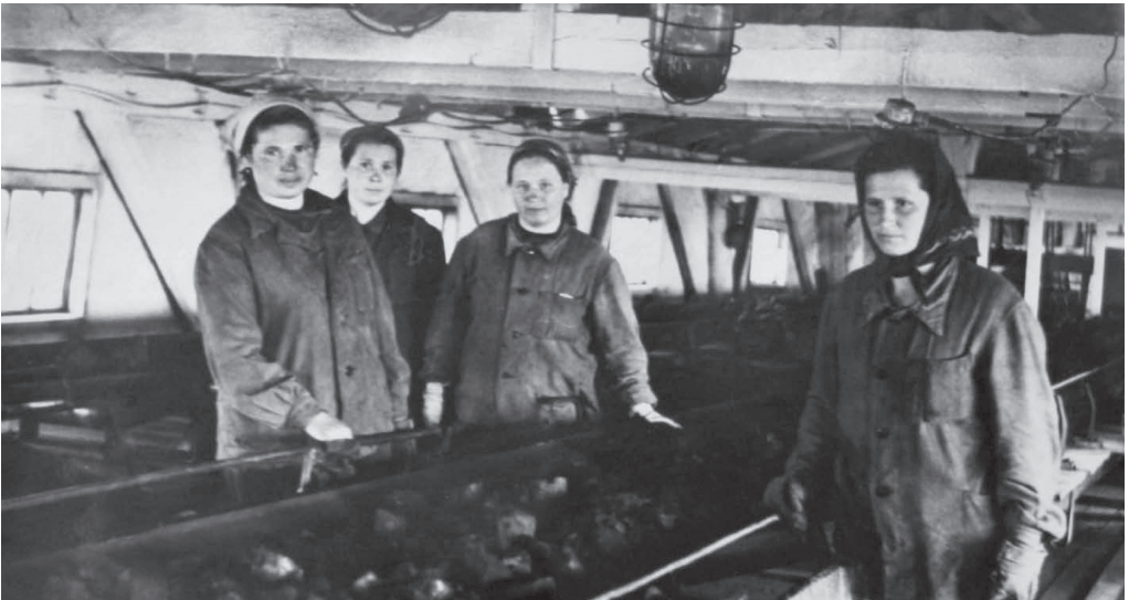
Работа по обогащению угля на транспортной ленте.
