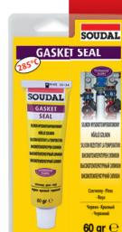
Силиконовый герметик, устойчивый к воздействию высоких температур (до 285 °С), топлива, масел, жиров, воды и морозостойких жидкостей. Заменяет любые уплотнительные прокладки из пробки, войлока, волокна, бумаги, асбеста и резины. Экономичная туба позволяет заполнить ок. 2 погонных м. стандартного шва.
