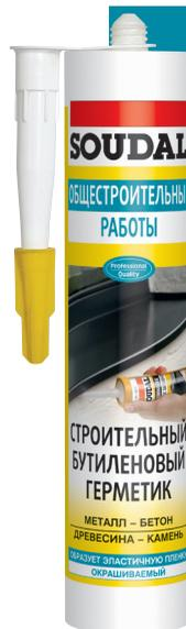
Герметик на основе полибутилена с очень хорошей адгезией к листовому металлу (жести) и большинству строительных поверхностей. Образует гладкую и эластичную пленку, которую можно окрашивать, в то время как под пленкой остается постоянно эластичным (не высыхает). Не оставляет пятен на краях пористых поверхностей.
