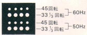
縞が右に流れる→F(速く)の方向に調節する
