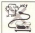
大型クーラーやセントラルヒーティングの電源電圧は、200Vになっていますので絶対に接続しないでください。
