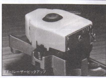
ラーにより発生する非点収差を利用して、フォーカシング。さらにディスクからの反射成分に含まれる、ビットによる振幅変調の位相成分を検出利用し、トラッキングを行う新しい方式です。従来の3ビーム方式に比べ、レーザー光の利用効率が高く、再生信号のSN比を大幅に改善。信号再生能力の高い新開発デジタル・アキュ・サーボや、フォトディテクタの形状改善とあわせて、ディスク表面の傷や指紋に対するプレイアビリティを大幅に向上させています。
