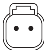
Чертеж разъема Е Влагозащищенный штекер DEUTSCH DT 06-25
