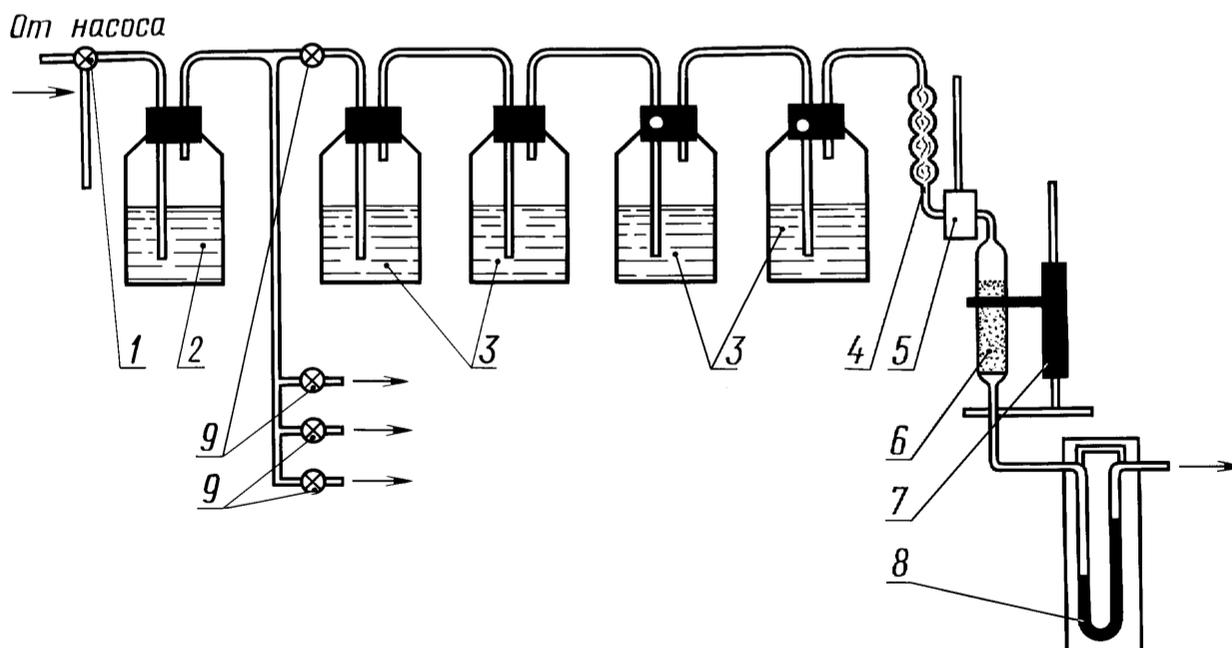
1 — трехходовой кран; 2 — склянка с водой; 3 — склянка с кислотой; 4 — брызгоуловитель; 5 — карман с термометром; 6 — динамическая трубка; 7 — штатив; 8 — реометр; 9 — двухходовые краны
