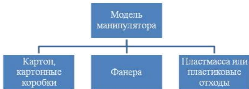
Для изготовления модели манипулятора вначале был выполнен макет из картона (картонных коробок), в котором детали скреплялись при помощи зубочисток, клея и пластилина (рис.6). Но такая конструкция была ненадежной, неустойчивой, поэтому было решено изготовить модель из фанеры.
