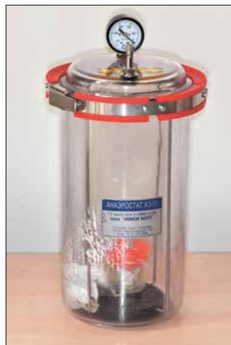
Рис. 3. Анаэробизация в компактном переносном анаэрозате АЭ-01. Образцы микробиологического материала готовы к транспортировке в лабораторию
