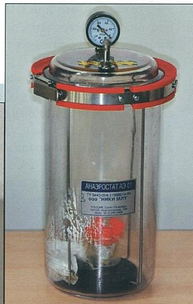
Рис. 7. Анаэробизация в компактном переносном анаэростате АЭ-01. Образцы микробиологического материала готовы к транспортировке в лабораторию.
