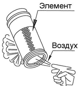
Фильтрующий элемент воздушного фильтра :
