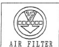
Засор воздушного фильтра
