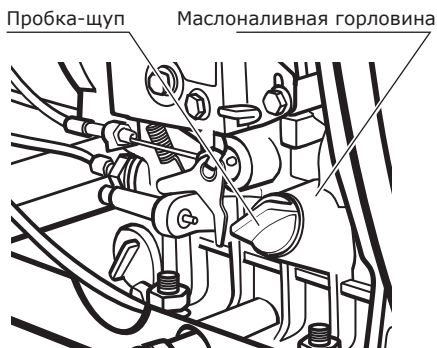
Рис. 2 Заполнение масляного картера
