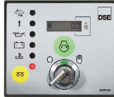
Модуль ручного управления двигателем, модель 702, предназначен для управления двигателем посредством переключателя с ключом и кнопок, размещенных на передней панели прибора. Данный модуль применяется для запуска и останова двигателя и индикации неисправностей. Он обеспечивает автоматический останов двигателя с указанием на неисправность с помощью светодиодных индикаторов.
