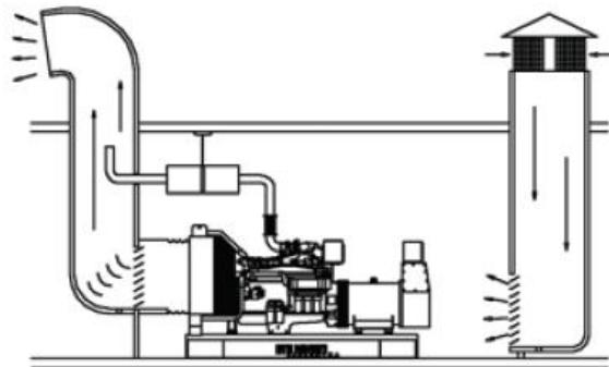
Следует избегать изгибов в канале выпуска горячего воздуха от радиатора и отводящей трубе от выхлопа дизель генератора. Впускные и выпускные отверстия для воздуха должны быть достаточно большими для обеспечения свободного прохода воздушного потока в помещение и из него. Ориентировочно, каждое из отверстий должно иметь площадь не менее, чем в 1,2..1,5 раза превышающую площадь средней части радиатора. Рекомендует впускное отверстие делать в 1,5-2 раза больше выпускного, так как
