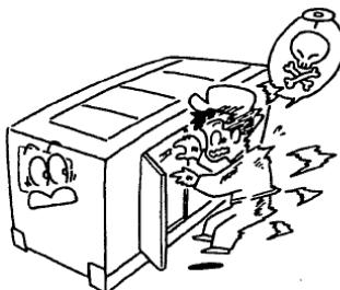
\*Перед эксплуатацией установки всегда закрывайте панель управления и затягивайте фиксирующие болты.
