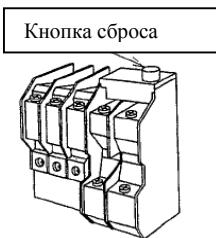
Это реле используется для включения автоматического выключателя (для 3 фаз), когда по цепи идет максимальный ток.
