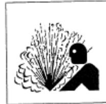
\* Не открывайте крышку радиатора во время работы или сразу после остановки двигателя, пока температура охлаждающей жидкости высокая.
