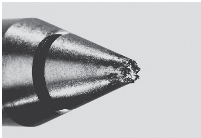
Рис. 31 Эрозия кончика катода в результате чрезмерно большой пульсации тока
