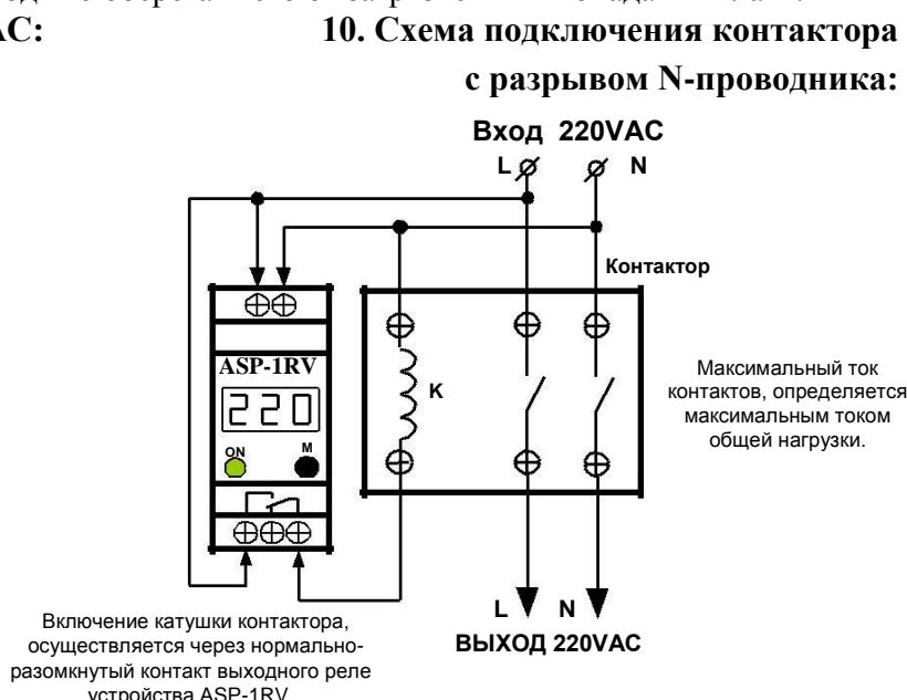
Перекидной контакт выходного реле может использоваться в различных схемах автоматики и сигнализации. Если ток контактов выходного реле превышает 5А, то необходимо при этом использовать контактор.
