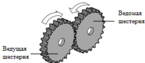
Ведущая шестерня приводится в движение внешней силой, например вашей рукой или двигателем. Любая шестерня, которая приводится в движение ведущей, называется ведомой. Ведущая шестерня предоставляет входную силу, а ведомая – выходную. Используя систему шестерней, можно добиться изменения скорости, направления или силы. Но здесь есть как преимущества, так и недостатки. Например, вы не можете одновременно получить на выходе и увеличение силы, и увеличение скорости.
