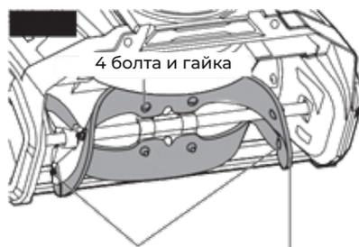
По четыре болта и гайки с каждой стороны (всего по 8 штук)
