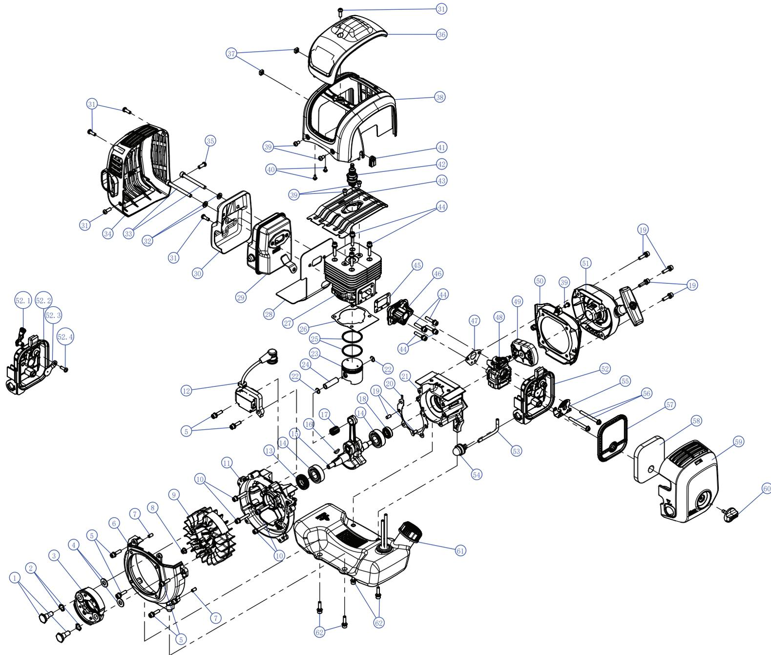
Модель агрегата: D 532 (Мотобур 2,58 см<sup>3</sup> 0,68 кВт/0.92 л.с.)
