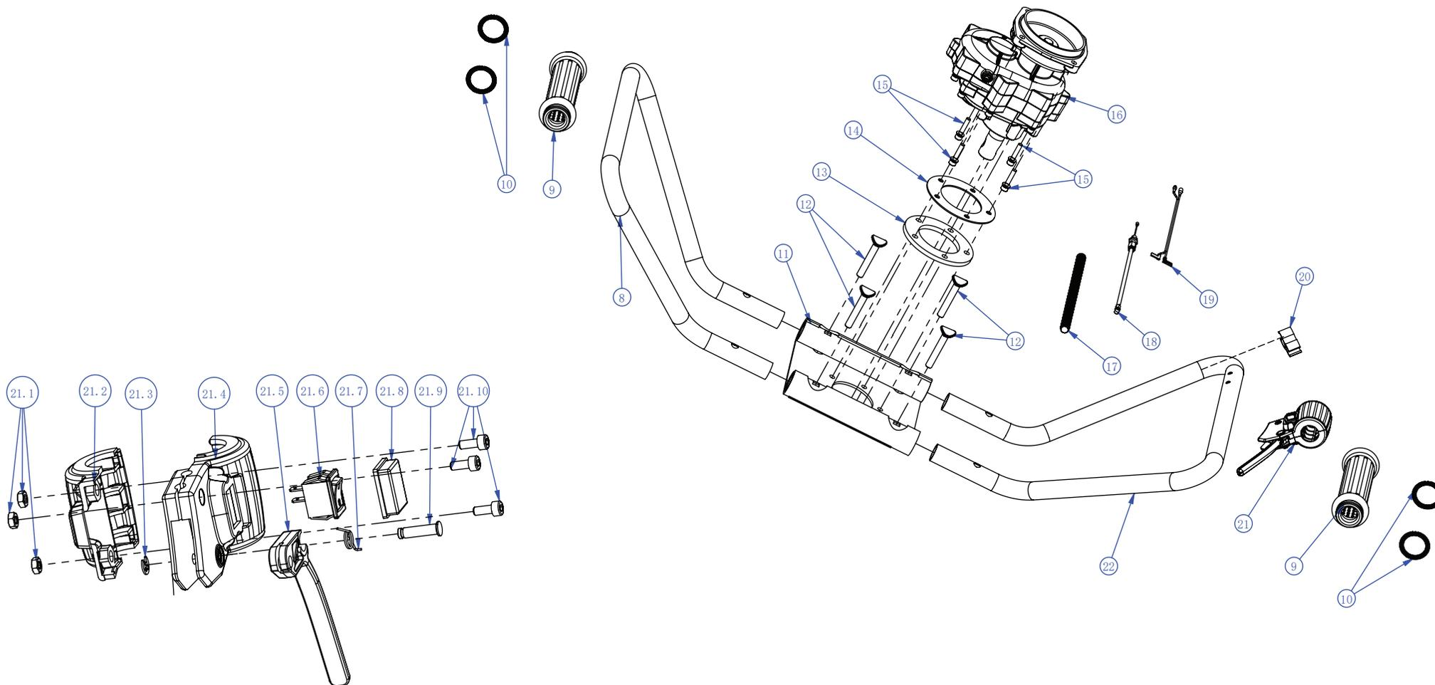
**Модель агрегата: D 532 (Мотобур 2,58 см<sup>3</sup> 0,68 кВт/0.92 л.с.)****Список запасных частей**
