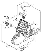
Корпус топливного бака
