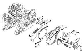
Тормоз пильной цепи, Натяжное устройство цепи
