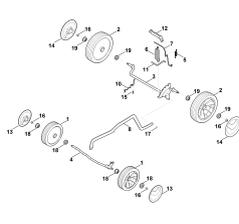
Механизм для перемещения, регулирования по высоте
