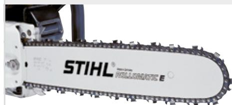
Сварной корпус шины STIHL Rollomatic E состоит из трёх металлических пластин, причем в средней пластине сделан большой вырез. Преимущество: высокая стабильность при малой массе. Для использования в самых разных областях направляющие шины модели Rollomatic E изготавливаются с головками (направляющими звёздочками) двух типоразмеров.
