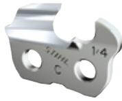
Пильная цепь комфорт-класса с низким уровнем вибрации обеспечивает очень высокую производительность пиления. Благодаря укороченной режущей грани зуба больше не требуется надавливание при врезании. Цепь достигает значительно более высокой скорости при врезании по сравнению с обычными цепями 1/4".
