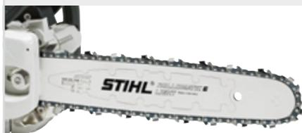
Сварной корпус этой облегченной шины состоит из трёх стальных пластин с вырезами большой площади. Свободные полости в шине заполнены полиамидом, армированным стекловолокном. Результат: уменьшение массы на 30%.
