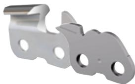
Специальная пильная цепь с усилением по всей поверхности из твёрдосплавных пластин с повышенной ударной вязкостью разработана для применения в режиме самых высоких нагрузок (например, доски с гвоздями, армированные материалы и бронестекло). Соединительное звено с 3 выступами перед каждым режущим зубом снижает риск повреждения зубьев.
