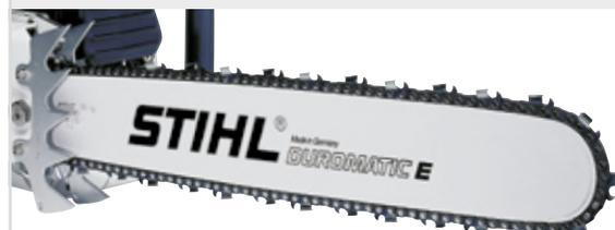
Шина STIHL Duromatic E — это в высшей степени прочная цельная шина для работ с бензопилами средней и высокой мощности. Цельный корпус шины изготовлен из сверхстойкой стали. Точка, на которую приходится основная нагрузка, дополнительно усилена твёрдосплавной облицовкой.
