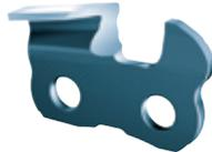
Пильная цепь Rapid Micro в исполнении комфорт-класса. Благодаря скосу на ножке зуба снижается уровень вибрации, а также достигается мягкий рез и низкий уровень шума.
