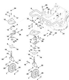
Регулировка высоты скашивания спереди, переднее колесо
