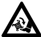
Не приближать руки и ноги к рабочему инструменту. Никогда не касаться вращающегося рабочего инструмента – **опасность получения травм!** Во время работы всегда стоять сзади защиты либо сбоку от агрегата – ни в коем случае не спереди в зоне рабочих инструментов.
